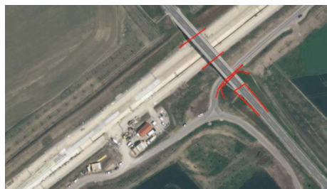
4) Erfassung von Bruchkanten, um die Brücke aus dem DGM auszuschneiden
